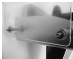
3. Inserire le due rondelle sui bulloni.
