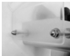
4. Nakręć dwie nakrętki kotłakowe.
