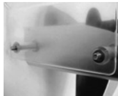
3. Die beiden Unterscheiben platzieren.
